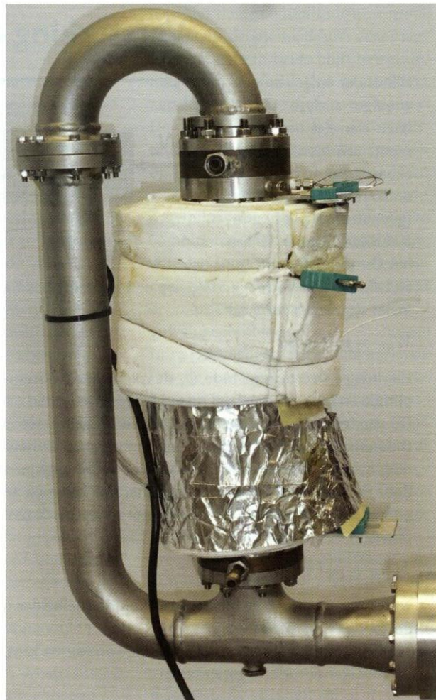
Figuur 6 De thermo-akoestische motor van ECN die het wereldrecord verbrak en het thermisch rendement verhoogde naar 32%.
