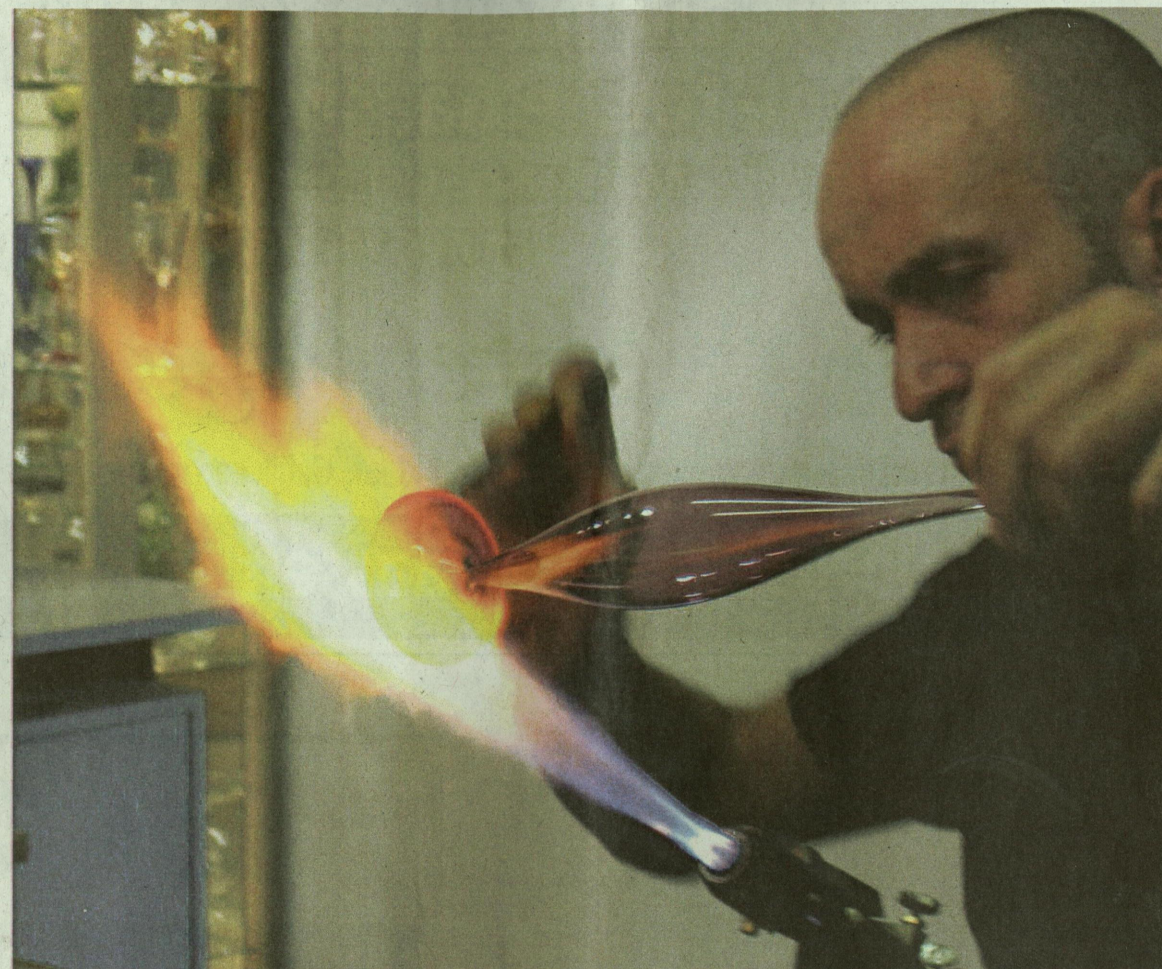
● Als een pijp glas in een felle vlam wordt verhit, kan deze spontaan gaan zingen. Hoe langer de pijp, hoe lager de toon.
