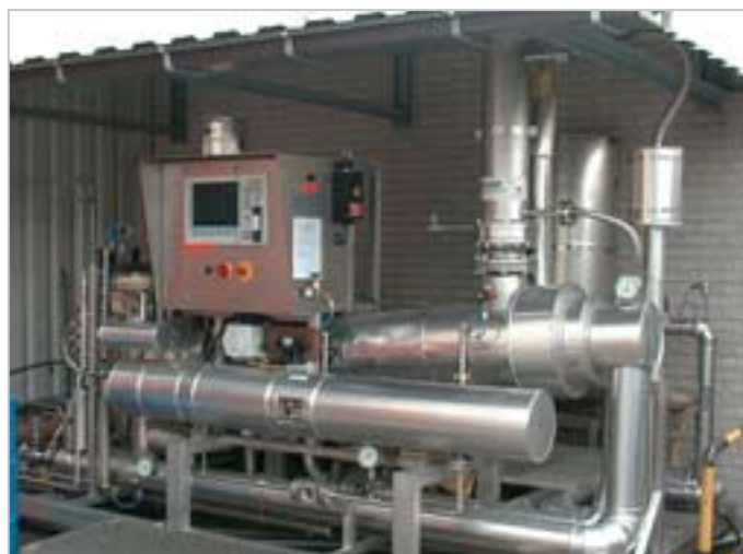
Pervaporatie-testopstelling van ECN. Hierin kunnen meerdere membraanbuisen met in totaal ongeveer 1 m 2 membraanoppervlak beproefd worden. (foto: ECN)
