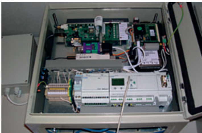
5. Gasunie VPP-node: kast met inhoud van ongeveer 20 liter.
