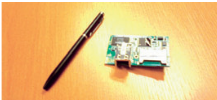
6. Embedded versie van PowerMatcher kan makkelijk in bestaande installaties worden geïntegreerd.
