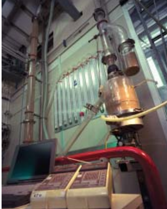
Testopstelling voor circulerend- wervelbedvergassing
