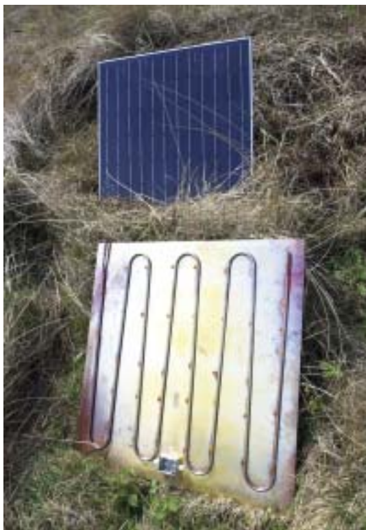
Een PVT-paneel is een zonnepaneel met een zonnecollector aan de achterzijde. Het systeem levert dus elektriciteit én warmte.
