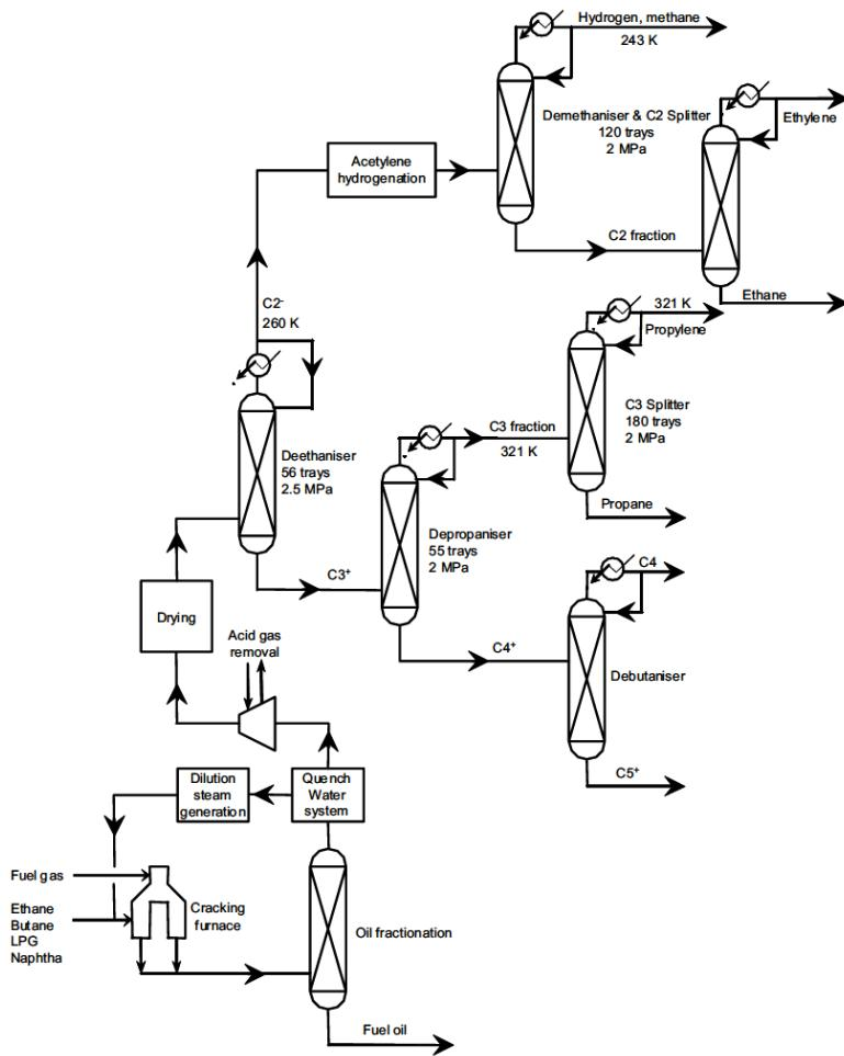
**Figure 2:** Process flow sheet of a typical steam cracking and olefin/paraffin separation plant **Fout! Verwijzingsbron niet gevonden..**
