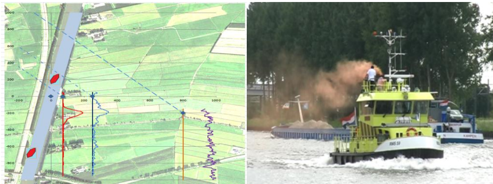
Figuur 12 Pluimen gemeten op drie stations van langsvarende schepen (rode blokjes) en 'snapshot' van een video met langsvarend testschip
