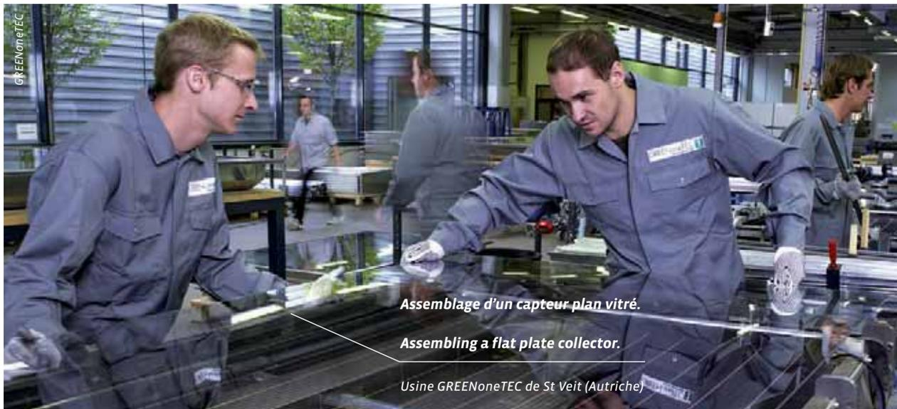
Assemblage d'un capteur plan vitré.
