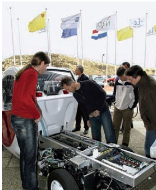
E&S heeft een belangrijke bijdrage geleverd aan de ontwikkeling van de Hydrogem. Dit voertuig is gebaseerd op de PEM brandstofcel.
