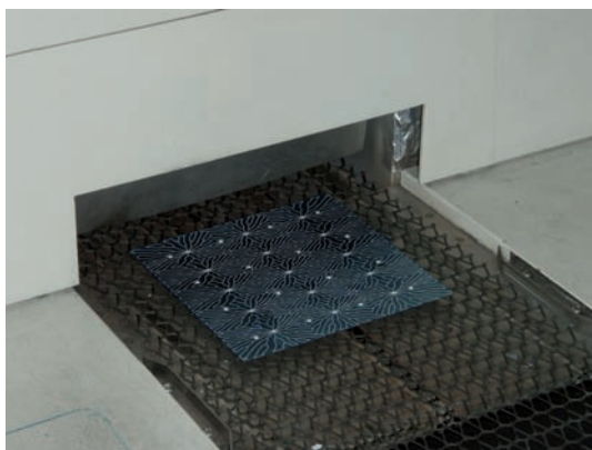
De eerste Pin-Up cel met aan beide zijden een silicium- nitride coating
