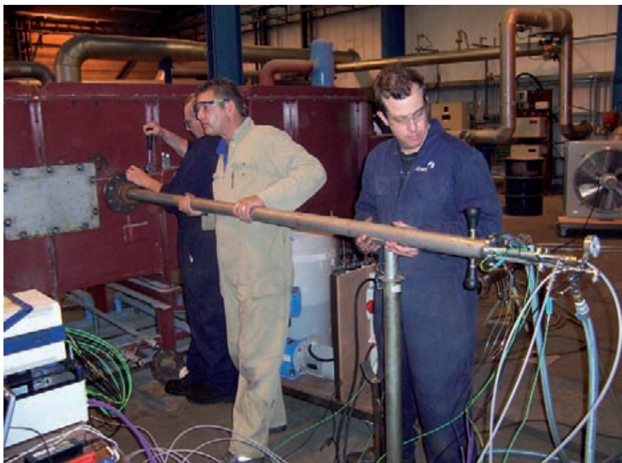
Depositiesonde in rookgas- kanaal geplaatst
