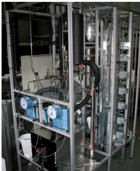
Nieuwe testinstallatie voor CO 2 afvangst
