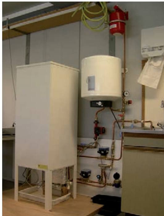
De compacte warmteopslag in een meetopstelling voor het testen van de prestaties van de warmteopslag.
