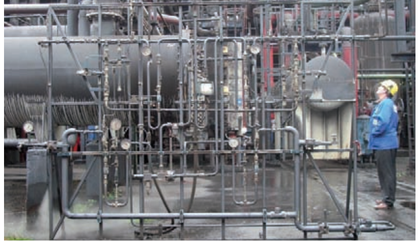
Membraantestinstallatie voor ammoniakafscheiding in Tertre (BE)
