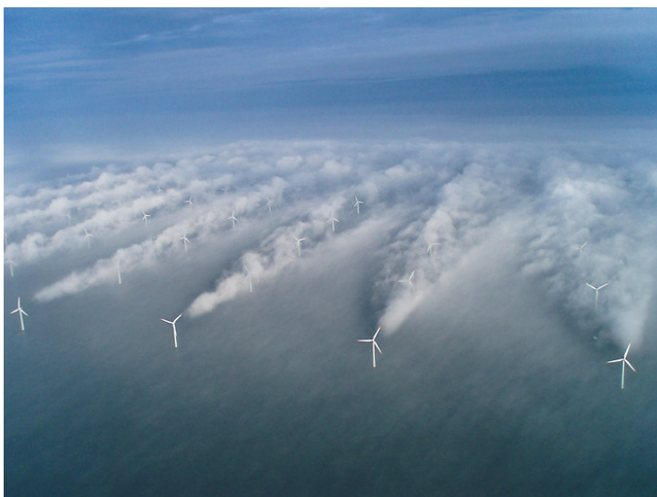
Figuur 1 Windverstoring door turbines: het zogeffect
