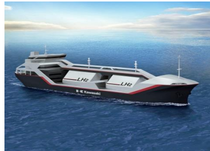
In aanbouw: kleine LH2 tanker; 116 m 2x1.250 m 3 ; diesel elektrisch (voor 2020)
