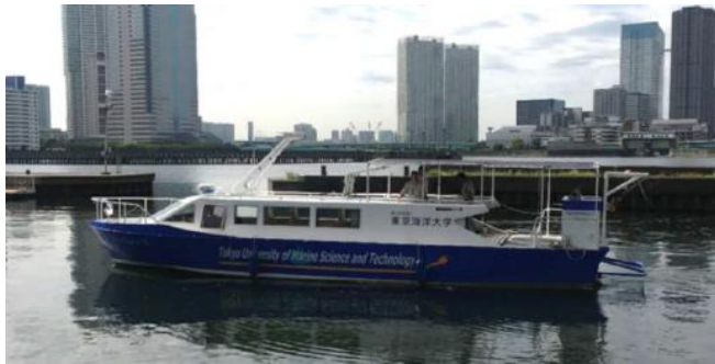
2014-..., onderzoeksproject, "haven patrouilleboot", batterij-diesel/brandstofcel-hybride, Raicho N, Tokio
