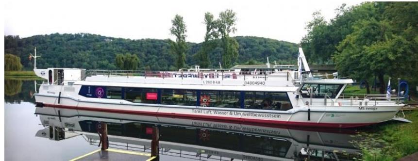
2017-... : Brandstofcel-elektrische aandrijving; methanol als brandstof (First Fuel Cell Vessel in Germany - Baldeneysee lake)
