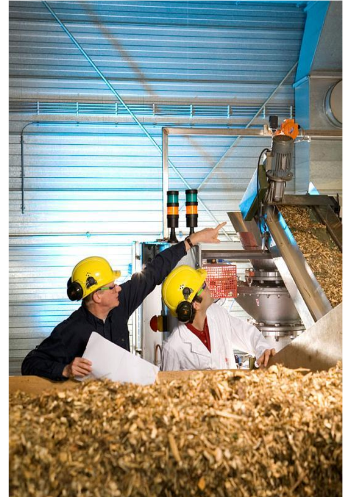
ECN 50 kg/h torrefaction pilot-plant
