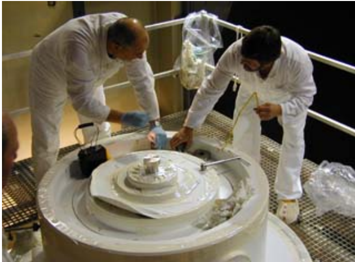
Figuur 3.1 Vastschroeven van de bouten op de deksel van de container
