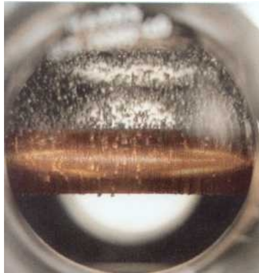
Figuur 7.4 Gegroefde buis voor verdamping
