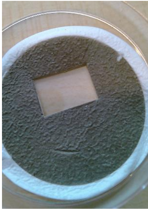
Figuur 3: PM 2,5 bemonsterd filter waaraan een roetanalyse is gedaan
