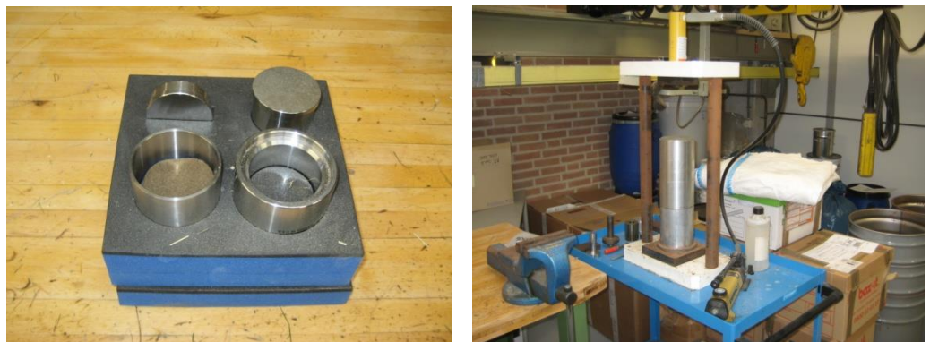
Figuur 3: Persmal (Carver Die 2¼") en hydraulische pers.
