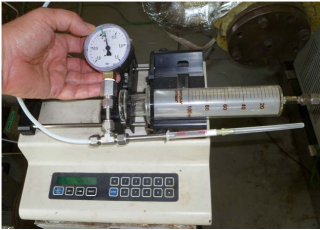
Figuur 13: Nemen van teermonster met adsorptie materiaal.
