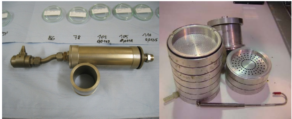
Figuur 8: Cascade impactor voor het meten van stofdeeltjes in verschillende grootte klassen.
