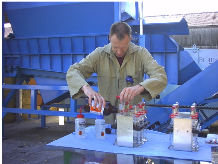
Figuur 11: Impingers voor het opvangen van stoffen; rechts het vullen van impingers.
