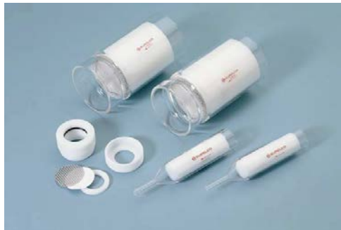
Figuur 14: ATB tube voor opvangen organische verbindingen en PUF Plug's voor dioxines.
