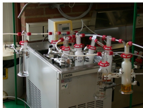
Figuur 12: Wasflessen in gebruik voor het nemen van een teer monster.
