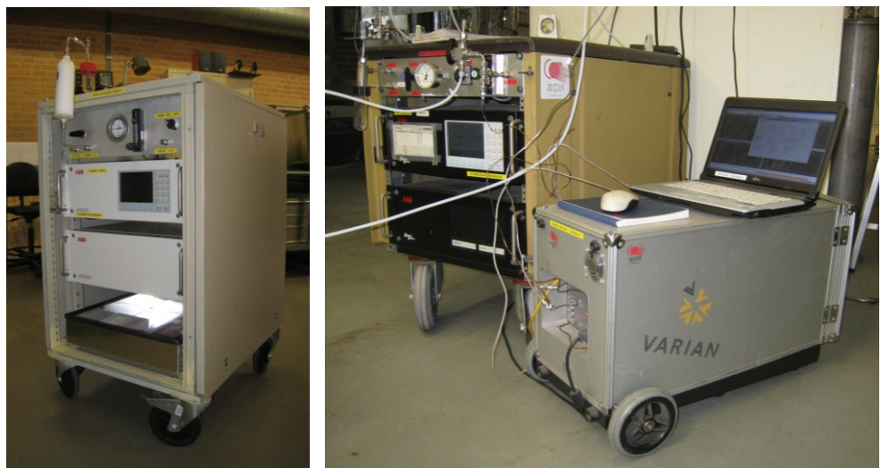
Figuur 5: Apparatuur voor het meten een stookgassamenstelling; rechts een micro gaschromatograaf.
