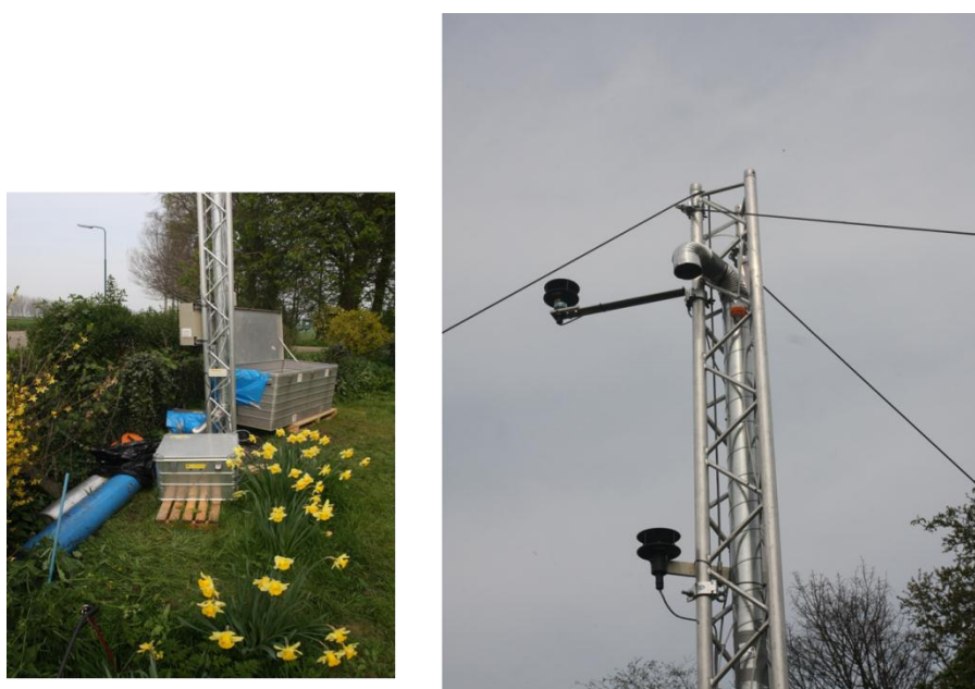
Figuur 2: Meetpunt 1. Links: Meetboxen aan de voet van de meetmast. Rechts: de top van de meetmast met de 11cm aluminium inlaat voor de aerosolmetingen, en de uithouders met de windsnelheid/windrichting meters. Op de hoogte van de aerosol inlaat bevinden zich ook de inlaten voor \text{NO}_x en \text{CO}_2
