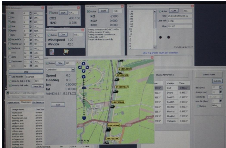
Figuur 3: User interface van het data acquisitiesysteem. In het midden het plaatje van de AIS data met de langsvarende schepen
