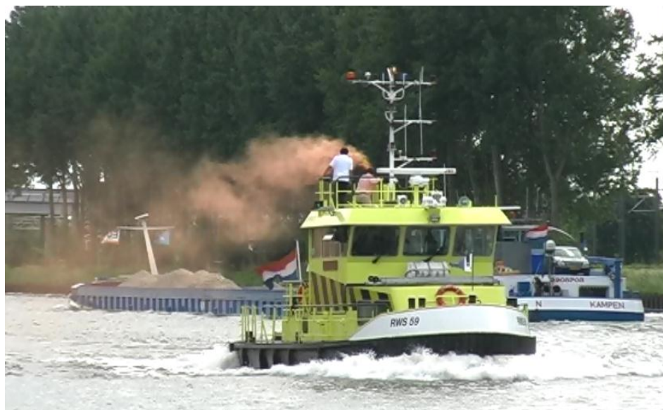
Figuur 30: Still van de video van de RWS99 van Rijkswaterstaat met bij de uitlaat een rookgenerator. Het is duidelijk waarneembaar dat de pluim na het schip naar beneden wordt getrokken
