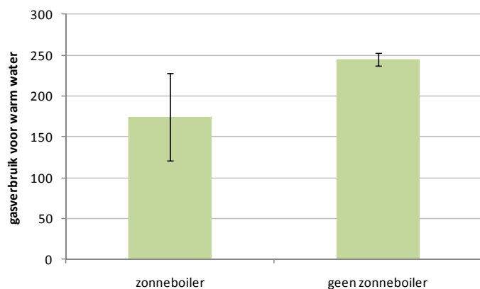
Figuur 3.8 Gasverbruik voor warmwaterverwarming met en zonder zonneboiler
