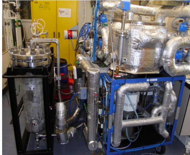
Figuur 3.11 Opstelling van de chemische warmtetransformator (links op de foto) en verbinding met de installatie voor verwarming en koeling met thermische olie (rechts op de foto)
