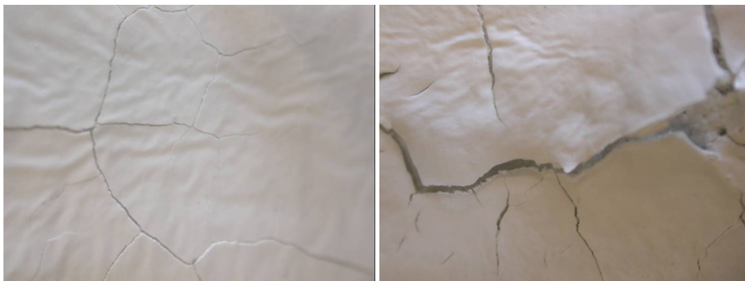
Figuur 3.4 Een laagje MgCl_2 met 3 %wt. aquazol (binder) op een aluminium substraat na drogen (links) en na een eerste cyclus (rechts)
