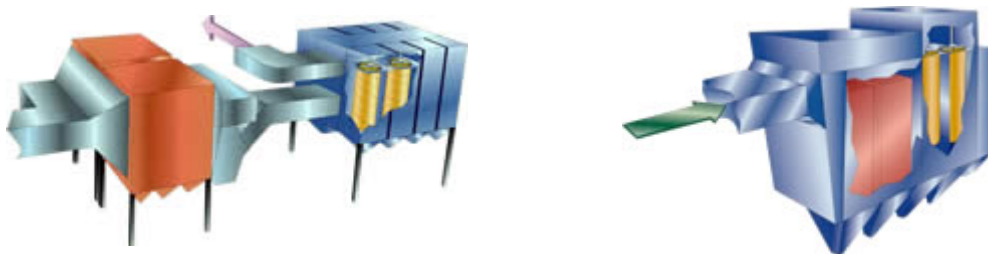
Figuur A.30 COHPAC-naplaatsing of integratie met het elektrofilter
