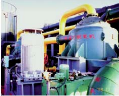
Figuur A.18 Roterend bed voor zuurstofverwijdering uit zeewater in de offshore
