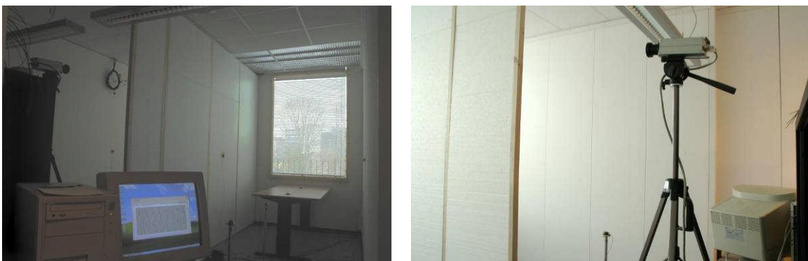
Figuur 14 Testruimte TU/e met meetcomputer en luminantiecamera
