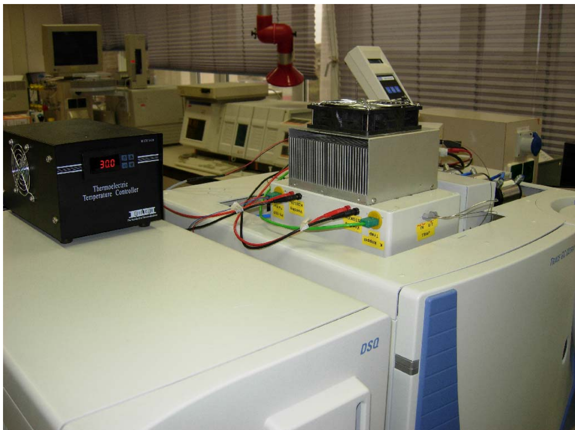
Figuur E.4 Test opstelling van het finale prototype in het laboratorium in Petten. De zwarte kast links is de temperatuurcontrole van de Peltier koeler. De witte doos linksonder is de Massaspectrometer. De wit-blauwe kast rechts is de gaschromatograaf. Het kastje boven op de GC is de eigenbouw cryogekeelde monstertrap
