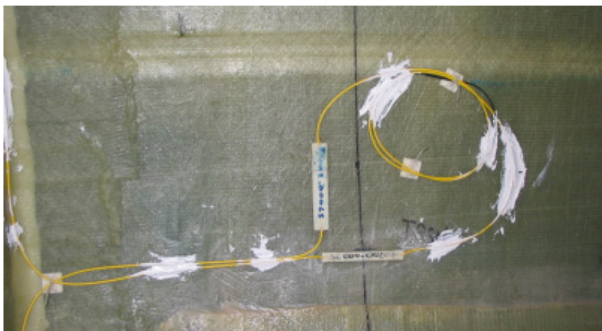
Figuur 4-3: Strain sensor (evenwijdig blad-as) en temperatuur sensor (loodrecht blad-as)
