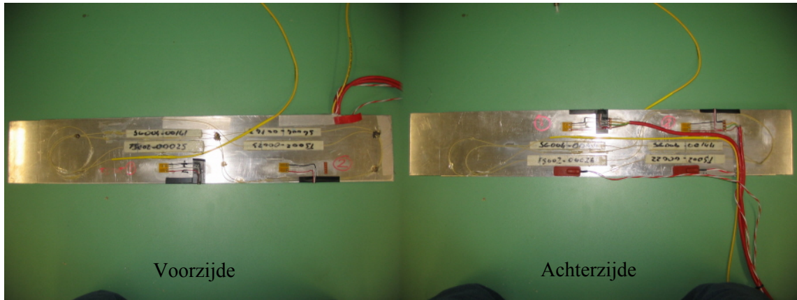
Figuur 3-7: ALU teststrip voor statische test
