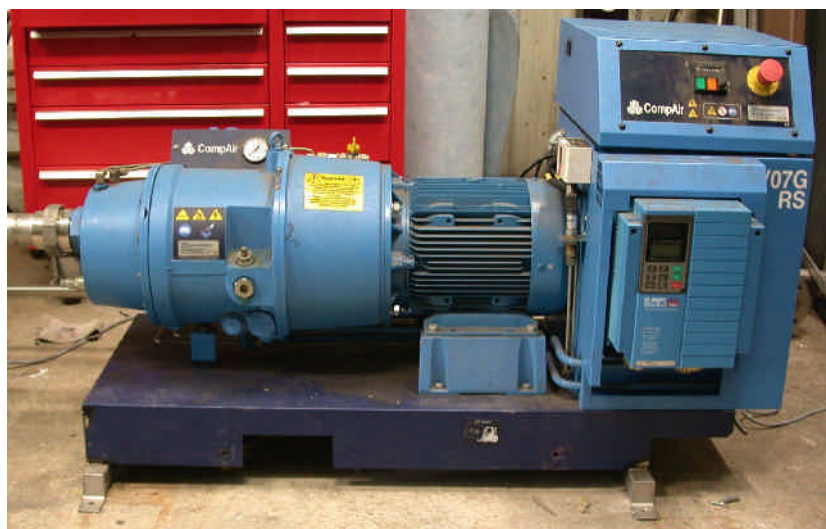
Figuur 2.5 Compressor om aardgas en productgas op druk te brengen voor microgasturbine.
