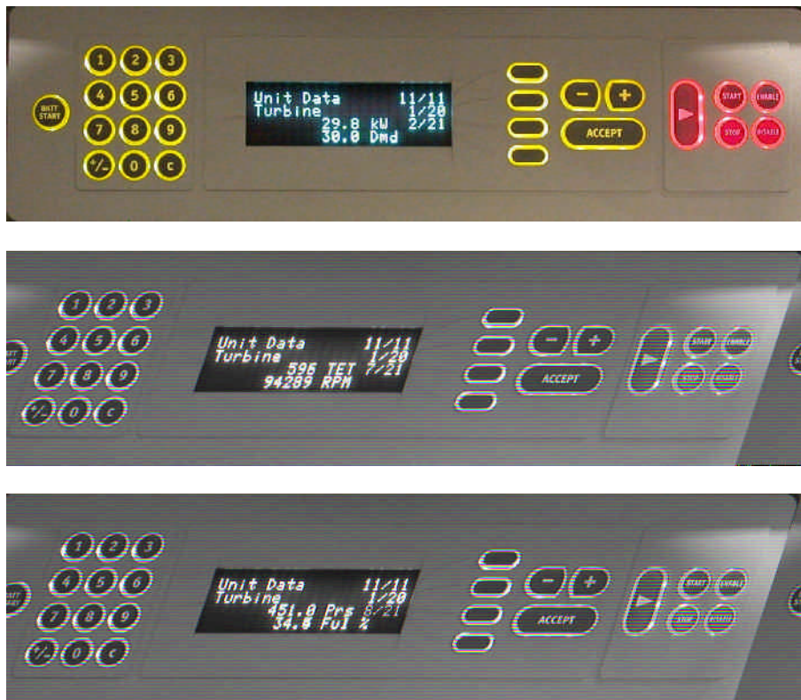
Figuur 2.9 Uitlezing geleverd vermogen (boven), turbine inlaat temperatuur en toerental (midden) en stand gasklep (onder) via bedieningspaneel microgasturbine.
