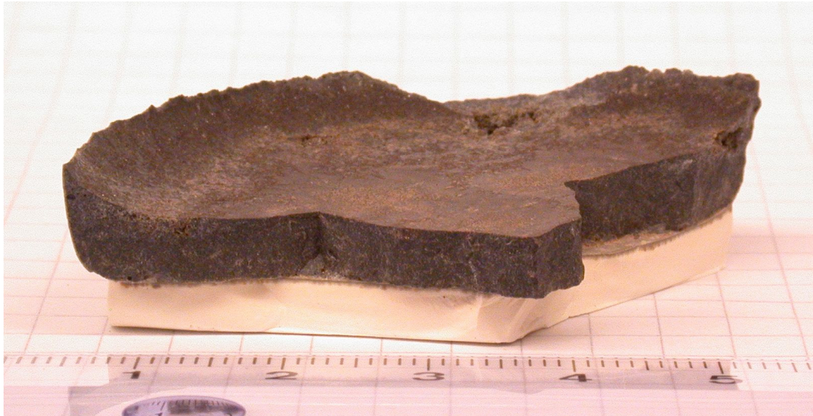
Figuur 4-1 Foto van monster uit kroes 5: een mooi microkristallijn synthetisch basalt
