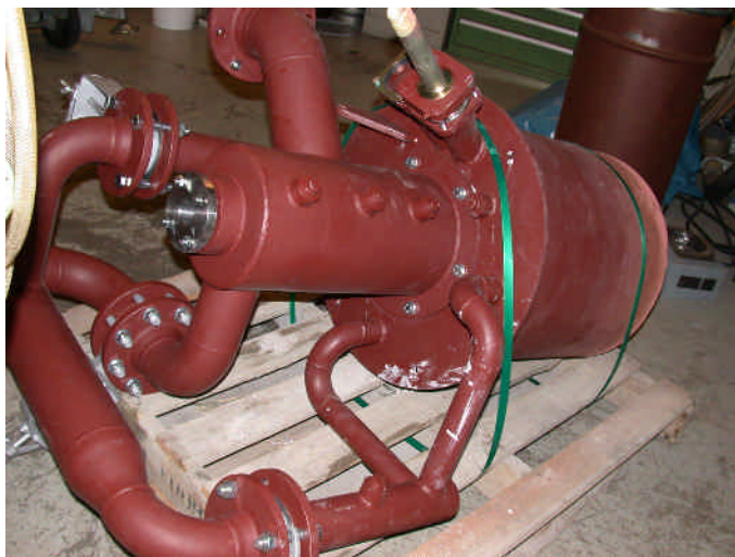
Figuur 4.4 Foto van de brander voordat hij in de ketel gemonteerd is
