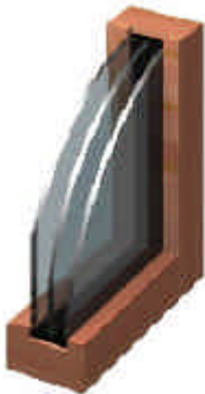
Figuur 3.6 Detail van drievoudig glas
