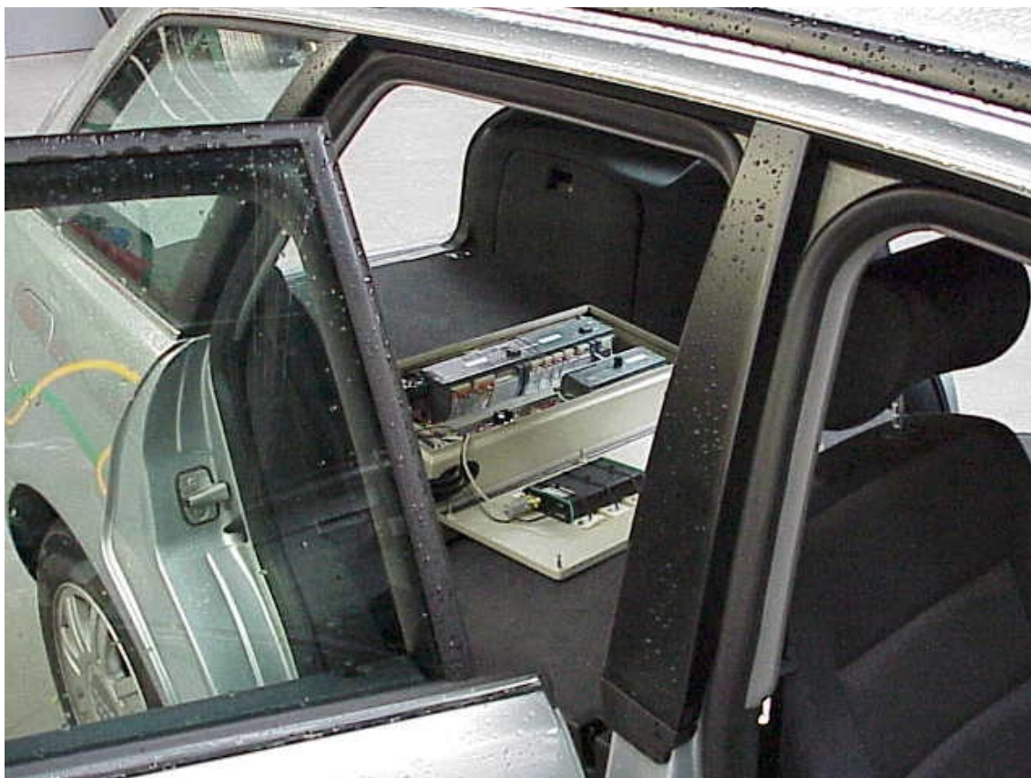
Figuur 3.4 Meet- en registratiesysteem ingebouwd in een Audi duo
