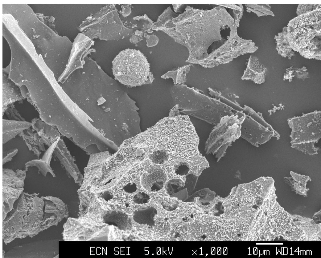
Figuur c. SEM opname van BIVKIN as (Biels)
