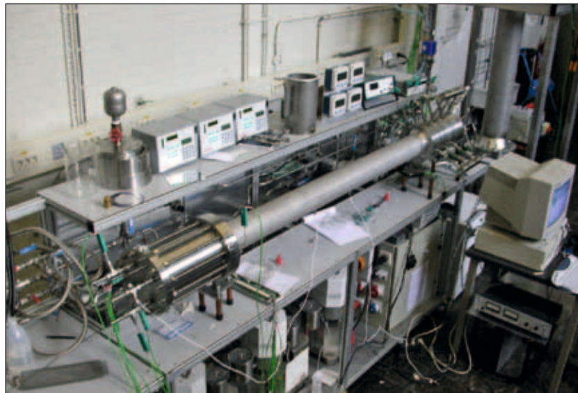
Figuur 22 Restwarmtegedreven motor met warmtepomp. Bron: ECN
