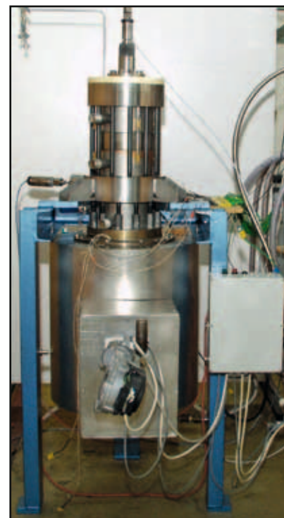
Figuur 24 Prototype van een Vuilleumier-warmtepomp. Bron: Universiteit van Dortmund
