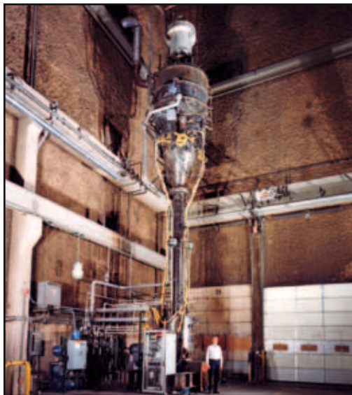
Figuur 21 Thermo-akoestische aardgasliquefier. Bron: Praxair/LANL
