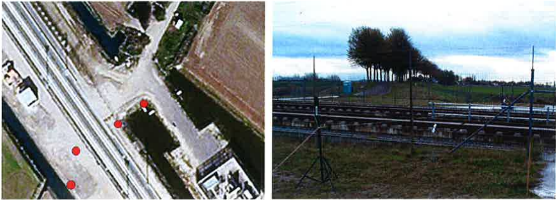
Figuur 2.4: De meetlocatie in De Wacht. Op de luchtfoto links ligt het spoor van de HSL (hier nog in aanbouw). De rode punten in deze foto komen overeen met de microfoonposities.
