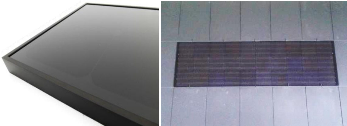
Fig. 2. Links: foto van een demonstratie-module van 2x2 IBC cellen toont het uniforme aanzicht. Rechts: foto van een BIPV dakelement zoals ontwikkeld in dit project door de Vlaamse projectpartners Soltech en Eternit, op basis van achterzijde gecontacteerde metal-wrap-through (MWT) zonnecellen. (bij MWT cellen is de voorzijde van de zonnecel niet geheel vrij van metallisatie, vandaar dat er in het BIPV element nog enige structuur in de module te zien is.)
