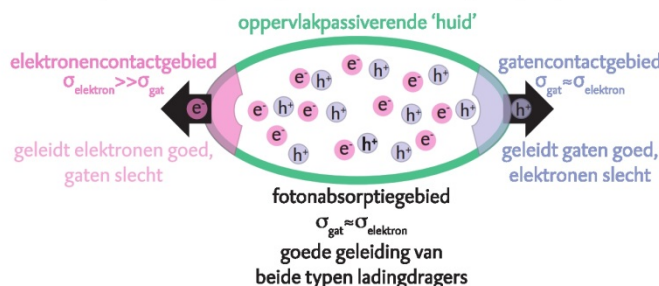
Figuur 1 Schema van een zonnecel. Het laat zien hoe de werking van een zonnecel principeel berust op ladingdragerselectieve contacten. Recombinatie via defecten moet geminimaliseerd worden, wat in het geval van een kristallijn silicium zonnecel betekent dat het waferoppervlak gepassiveerd moet worden. Overgenomen met toestemming uit referentie [2].
