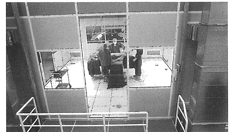
Meetopstelling in de als OK ingerichte cleanroom van TNO Bouw
