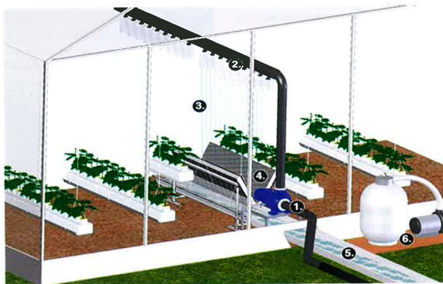
-Figuur 1- Het watergordijn schematisch weergegeven
