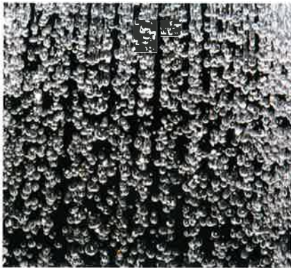
-Figuur 2- Vallende waterdruppels vormen een watergordijn dat warmte en vocht uit de kaslucht opneemt. Een opstelling per 10 m levert een koelvermogen van gemiddeld 500 W/m 2 . Rechts de opvanggoot.
