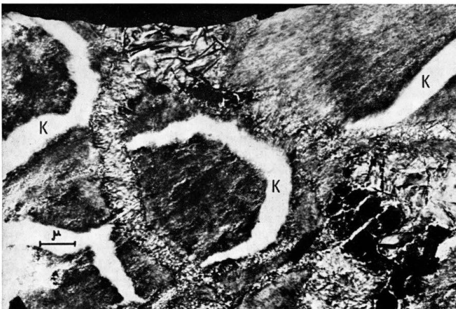
Fig. 2. Ultra dunne coupe door gasbeton. K zijn kanalen ter grootte van een micron begrensd door naalden en fijn korrelig materiaal.
