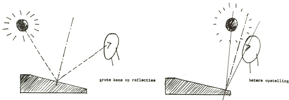
Figuur 14. Positionering van de lampen i.v.m. reflecties
