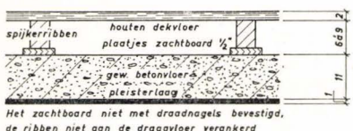
Figuur 1. Verbetering geluidisolatie vloeren. Zowel een vrijdragend plafond als een betonnen of houten dekvloer verhogen de lucht- en contactgeluidisolatie van een vloer. Of deze verbetering tot uiting komt in de geluidisolatie tussen de twee kamers, hangt af van de mate van flankerende transmissie
