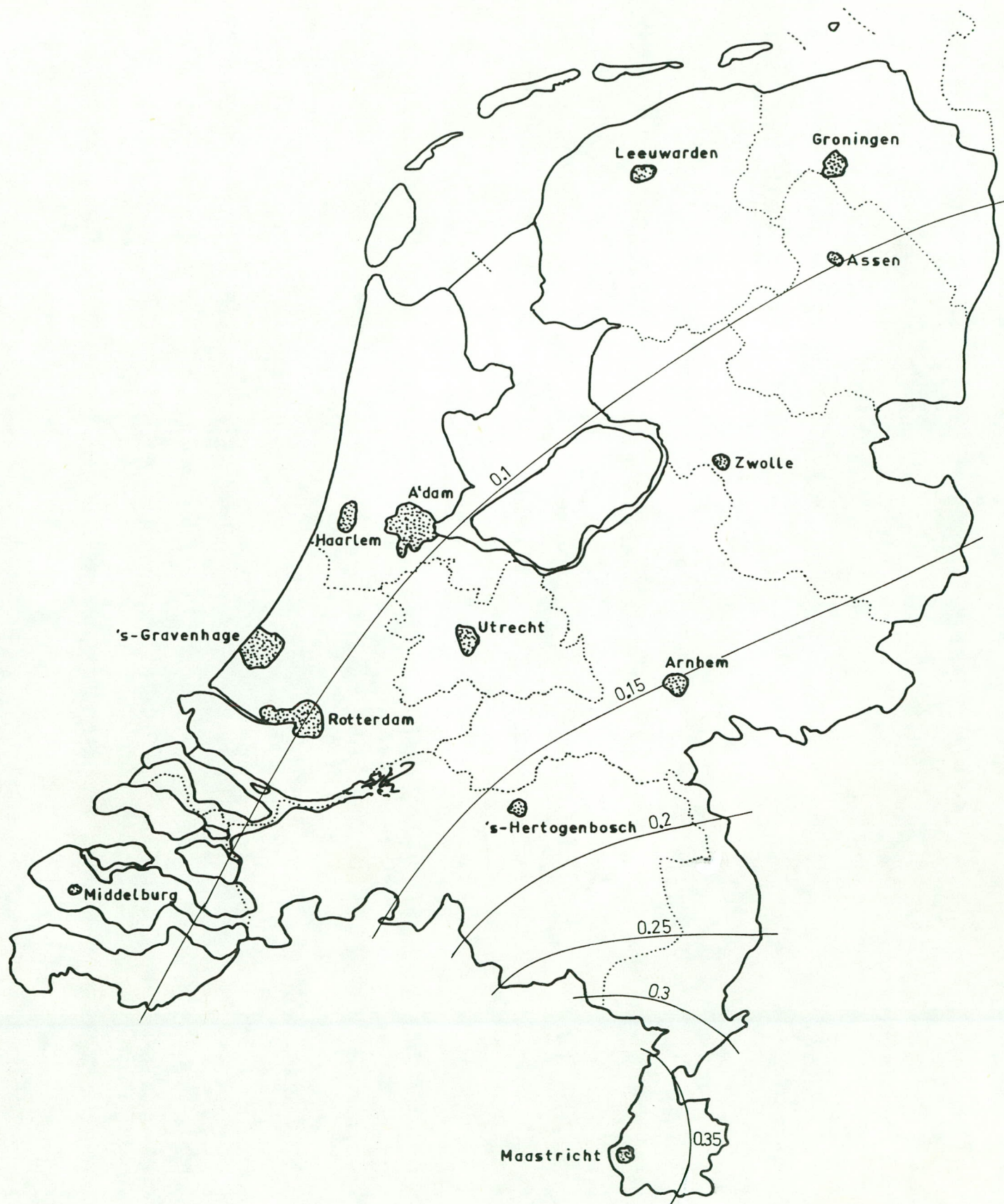
Figuur 1. Bijdrage van buitenlandse bronnen tot de niveaus van de "lagere" PAK's in de periode oktober 1982 - oktober 1983. Gegeven is het relatieve groepsgemiddelde. Vermenigvuldigen met de schalingsfactoren van tabel 7 geeft de absolute niveaus in \text{ng/m}^3 .
