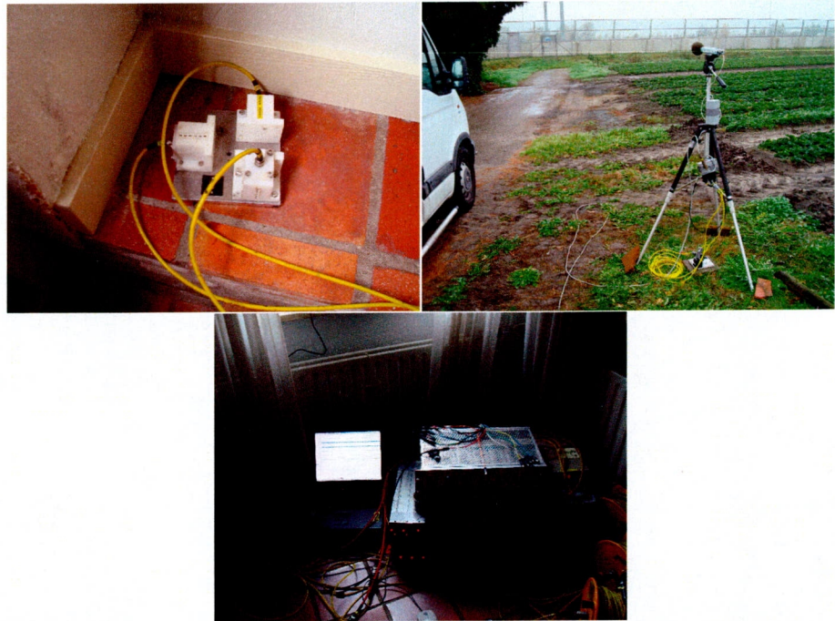
Figuur 2 Enkele foto's van de meetopstelling: met de klokwijzers mee: versnellingsopnemers bij een punt op de fundering; opnemers bij het meetpunt op het maaiveld; acquisitiesysteem.
