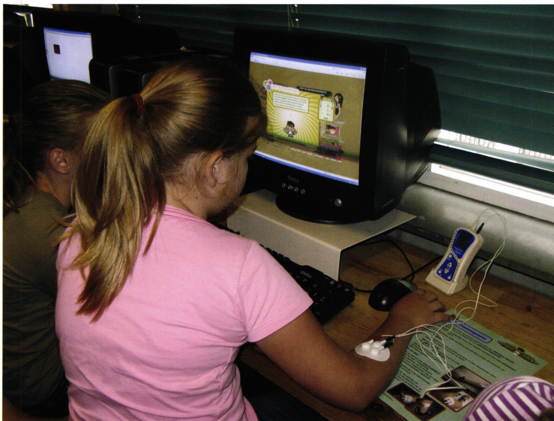
Foto 1. Meisjes die tijdens het computergebruik de spierspanningsmeter gebruiken: hierdoor krijgen ze feedback over de mate van inspanning van de onderarmspieren tijdens het gebruik van de muis (zie witte sensor op de onderarm).
