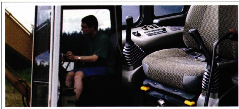
Figuur 1. De besturing met handels (links) is een jaar of tien geleden vervangen door de joystickbesturing (rechts)
