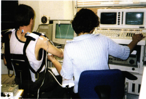
Figuur 1. De meetopstelling. Het tuijje werd omgedaan als een rugzak en was voorzien van zacht materiaal om het comfort te vergroten en de druk te verdelen. In de cirkel is het lusje te zien waaraan de last werd opgehangen. De computermonitor geeft het feedbacksignaal voor de knijpkracht aan. Rechts het Doppler apparaat.
