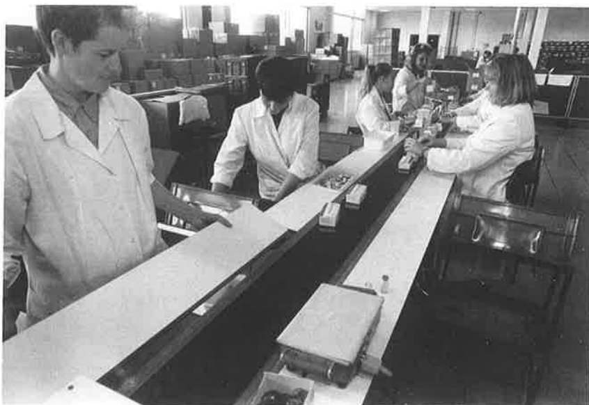
De verwisselbare platen maken het mogelijk dicht bij de band te zitten. Foto: Peter Pennarts
