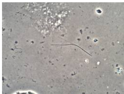
Figuur 2.2 Vezel in FCM bij een vergroting van 500x
