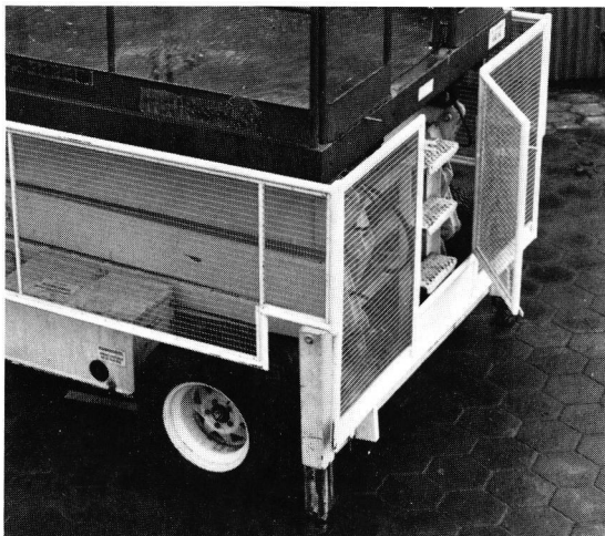
Een metalen gaasscherm kan beknelling tussen de scharconstructie voorkomen.
