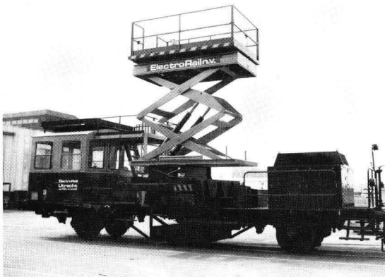
Schaarhoogwerker op rails voor aanleg en onderhoud van bovenleidingen.
