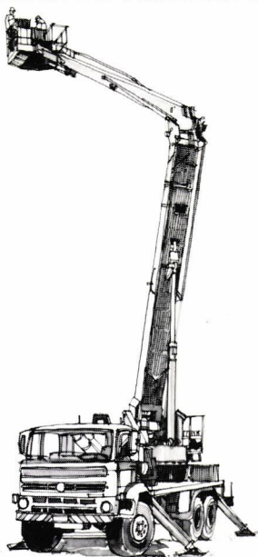
Mobiele hydraulisch aangedreven hoogwerker
