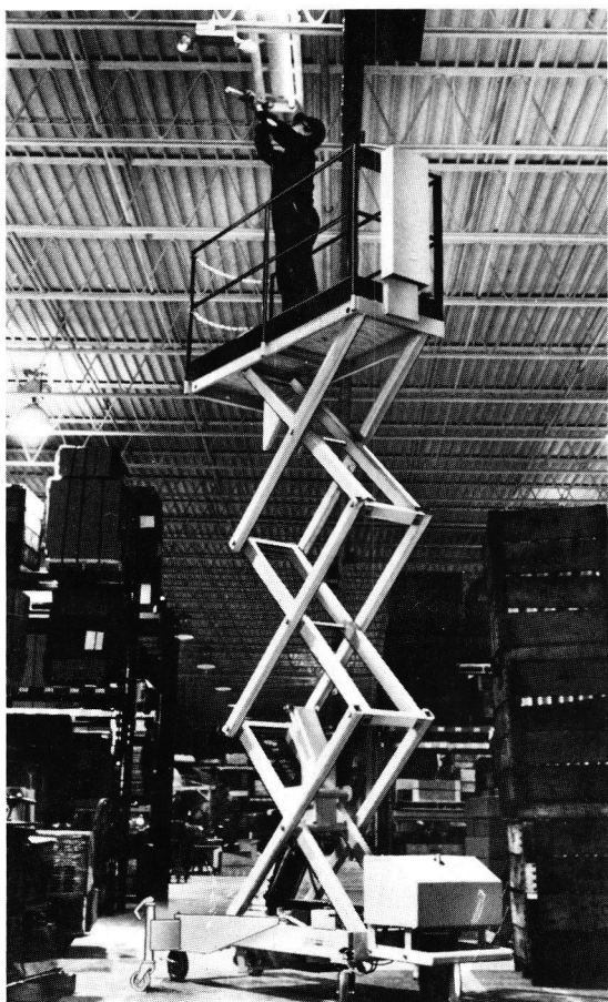
Hoogwerkers zijn er in diverse uitvoeringen. Hier een schaarhoogwerker in actie.
