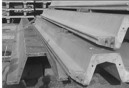
Figuur C26: De damwand (2003) in C105/120 in vergelijking met C55/65
