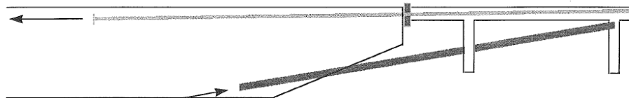
figuur 4.2 Bevestiging uitbreidingsligger aan vlakke plaat viaduct
