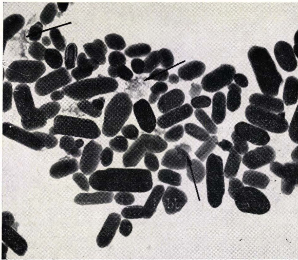
Fig. 1. Directe opname van een titaandioxyde pigment. Bij de pijltjes, losliggende bedekkingslaag. Vergr. 25.000 \times .
