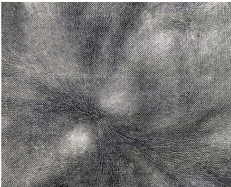
Fig. 7. Directe opname van een met fosforwolframzuur gekleurde nylon 6 film verkregen uit een oplossing. Witte fibrillen van 35 Å breed representeren het kristallijne gedeelte. Vergr. 113.000×.
