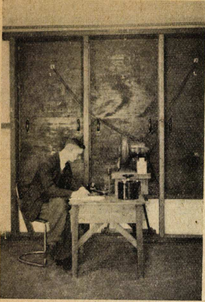
De apparatuur voor het meten van de luchtdoorlaat door ramen.
